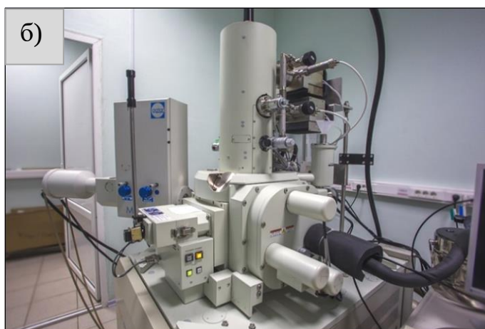
Рисунок 7 а) Схема рабочей камеры сканирующего электронного микроскопа, б) фотография СЭМ JEOL JSM 7001FA
