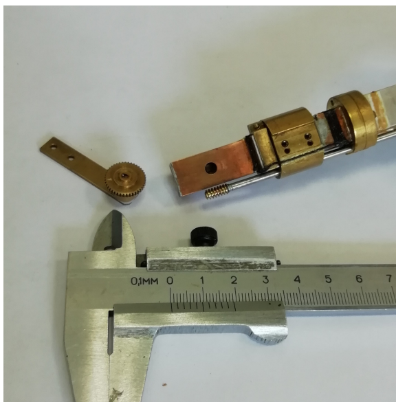
Рисунок 5: Фрагмент экспериментальной ячейки в спектрометре с прямоугольным резонатором с возможностью вращения образца. Рабочие частоты от 17 ГГц и выше.
