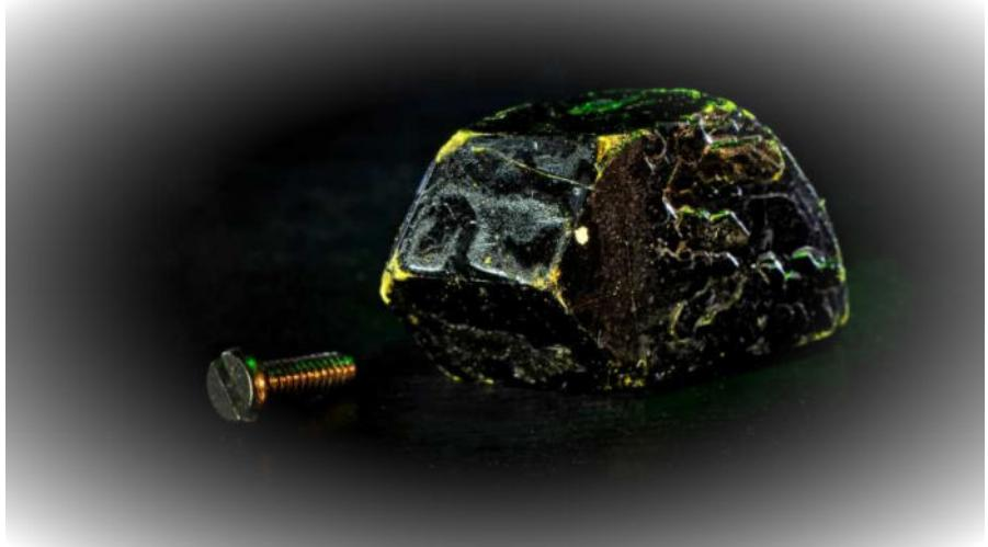
Рис. 11.5: Вид образца DTN, для масштаба рядом изображён винт M1.6 длиной 5 мм. Изображение с сайта Лаборатории нейтронного рассеяния и магнетизма Федеральной технической школы Цюриха [267].
