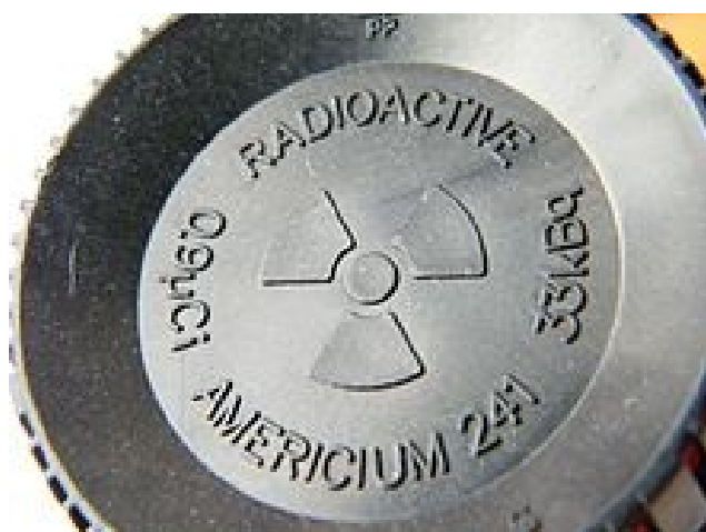
Рисунок 14: Контейнер для амерция-241 в бытовом детекторе дыма. С сайта [18].
