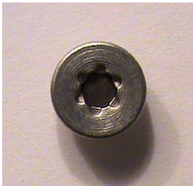
Рисунок 13: Капсула амерция-241 из бытового детектора дыма. Оболочка - алюминий, тёмный элемент в центре – диоксид амерция-241. С сайта [18].
