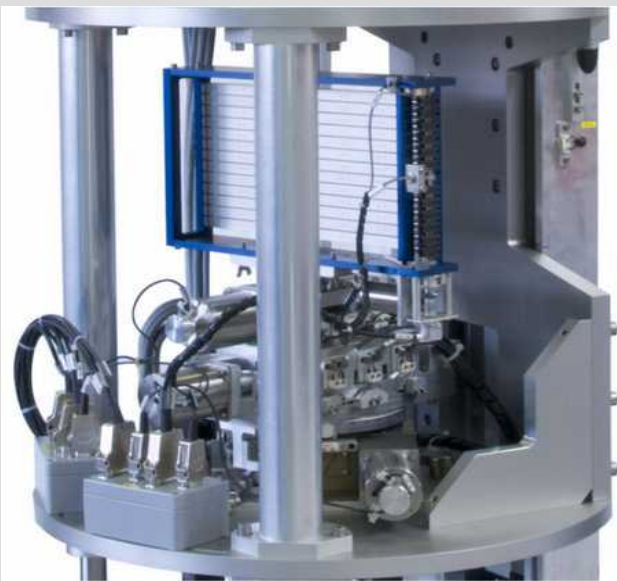
Вертикальный фокусирующий монохроматор с кристаллами ориентированного пиролитического графита производства компании Swiss Neutronics. Размер 300x170 мм, состоит из 13 полос на которых находится 78 кристаллов графита с мозаичностью около 0.1 градуса, минимальное фокусное расстояние 600 мм. С сайта производителя
