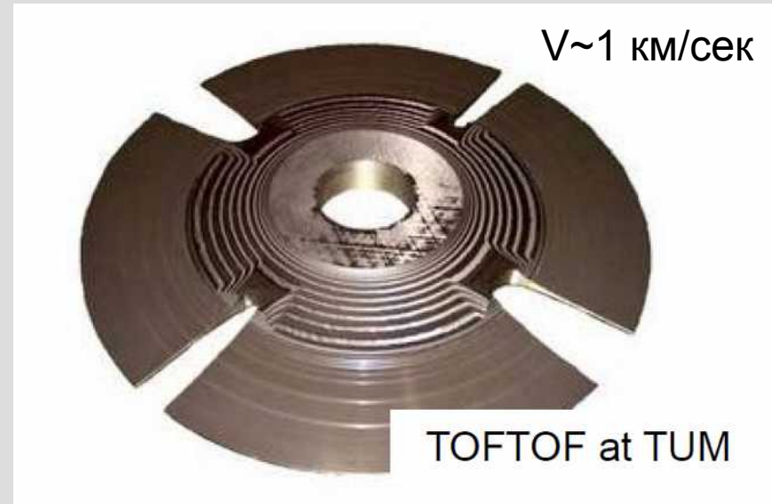
Диск прерывателя пучка с времяпролётного спектрометра в Техническом университете Мюнхена. Поперечный размер ~10 см. Из лекций проф.А.Желудева
