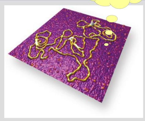
Изображение молекулы ДНК, полученное атомным силовым микроскопом. Размер области сканирования 530 нм. С сайта Intertech Corporation, AFM Images, 2012, www.intertech-corp.ru
