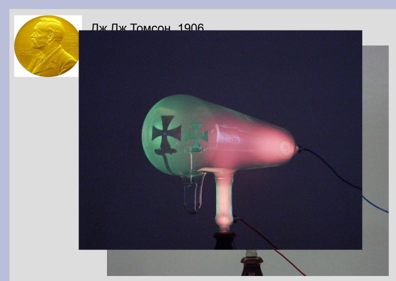
Трубка Крукса. Слева — без напряжения. В центре — приложено напряжение, на экране наблюдается «тень» от анода. Справа — смещение «тени» при поднесении магнита. С сайта wikipedia.org, Crookes tube, 2017, https://en.wikipedia.org/wiki/Crookes tube
