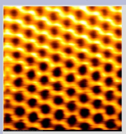
Изображение поверхности графита, полученное при помощи атомного силового микроскопа. Размер кадра 2×2 нм2. С сайта EP6, University of Augsburg, AFM images gallery, 2012, http://www.physik.uni-augsburg.de/exp6/imagegallery/afmimages/afmimages e.shtml
