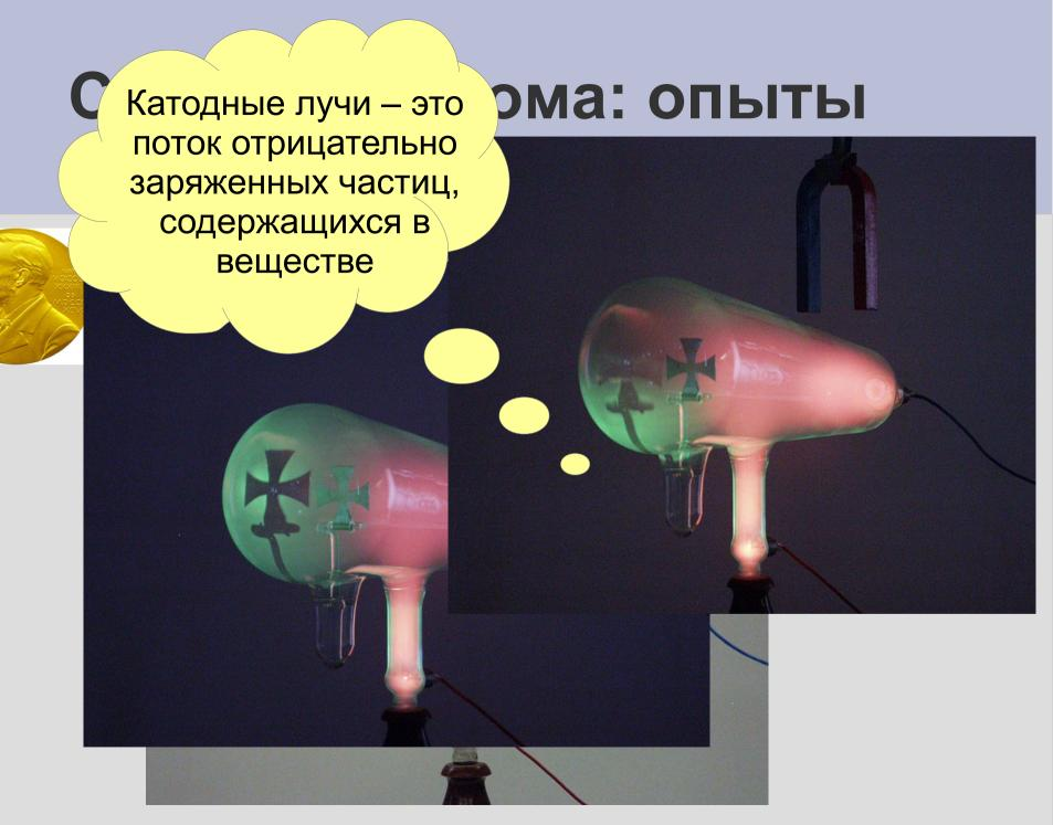
Трубка Крукса. Слева — без напряжения. В центре — приложено напряжение, на экране наблюдается «тень» от анода. Справа — смещение «тени» при поднесении магнита. С сайта wikipedia.org, Crookes tube, 2017, https://en.wikipedia.org/wiki/Crookes tube
