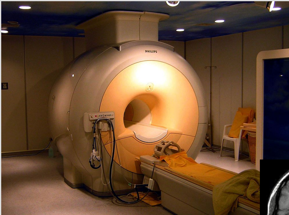
Слева: Современный ЯМР-томограф с полем до 3 Тл. Справа: примеры ЯМР-томограмм мозга с разной обработкой сигнала.
