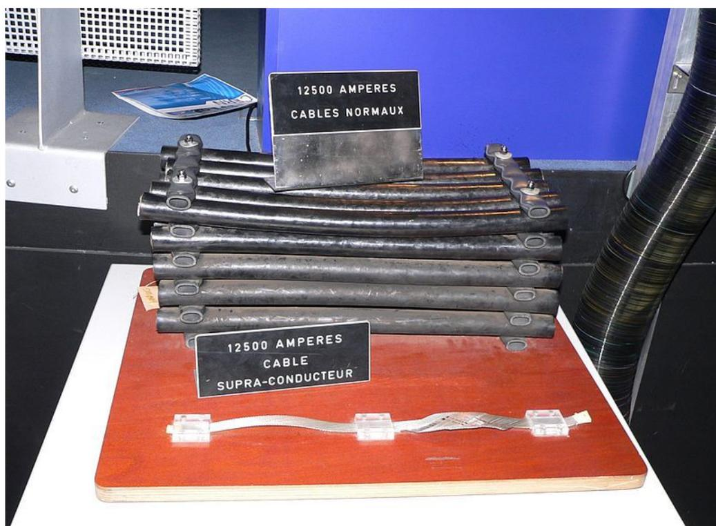
*Рисунок 5: Используемые в ускорителях ЦЕРН кабели на 12500 Ампер. На заднем плане: из несверхпроводящего материала, на переднем плане: из сверхпроводника. С сайта [9].*
