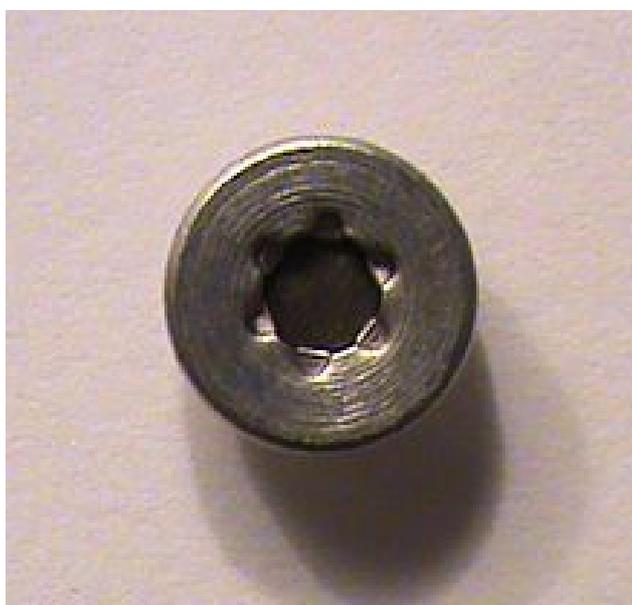
Рисунок 14: Капсула амерция-241 из бытового детектора дыма. Оболочка - алюминий, тёмный элемент в центре - диоксид амерция-241. С сайта [18].
