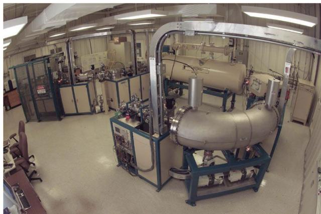
Рисунок 31: Масс-спектрометр, используемый для радиоуглеродного анализа. С сайта [39].
