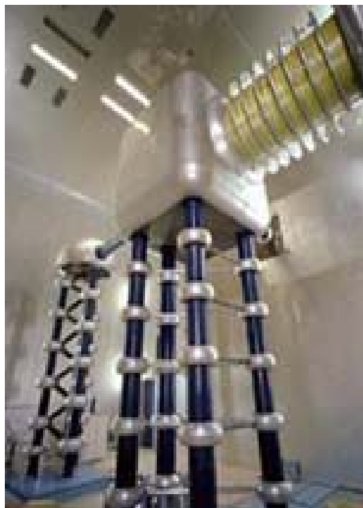
Рисунок 18: Протонный ускоритель Кокрофта-Валтона на 750 кэВ, являющийся первой ступенью ускорительного комплекса лаборатории Фермилаб (США). С сайта [14].
