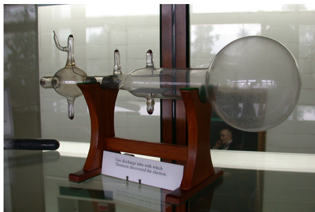
Рисунок 37 Трубка, в которой Дж.Дж.Томсон провёл опыты, приведшие к открытию электрона. Катод располагается в левом (дальнем по рисунку) конце трубки, в средней части видна пара отклоняющих электродов, по действию которых было определено наличие заряда у электрона. С сайта музей Кавендишской лаборатории [32].
