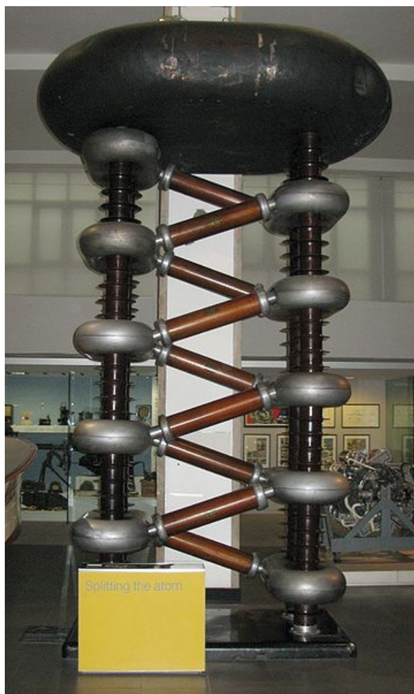
Рисунок 16: Умножитель Кокрофта-Валтона, 1937 год. С сайта [12].
