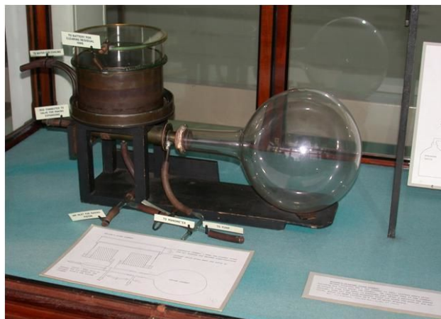
Рисунок 4: Сделанная Ч.Вильсоном камера Вильсона. Из экспозиции музея Кавендишской лаборатории. С сайта [3].
