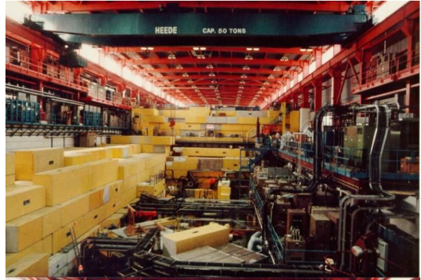
Рисунок 22: Экспериментальный зал циклотрона Триумф (Ванкувер, Канада). Циклотрон на заднем плане скрыт под бетонными блоками толщиной около 5 метров. С сайта [19].
