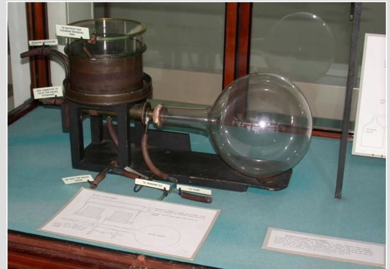
Сделанная Ч.Вильсоном камера Вильсона. Из экспозиции музея Кавендишской лаборатории.
