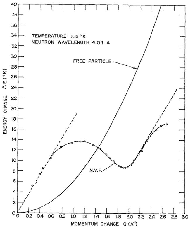
Рисунок 1: Спектр элементарных возбуждений в гелии-4 ниже лямбда-точки, определённый по неупругому рассеянию нейтронов. Температура 1.12 К, давление равно давлению насыщенных паров.
