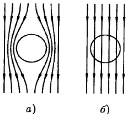
Рис. 1.2. Магнитное состояние идеального проводника при  $T < T_c$ ,  $H > 0$  зависит от предыстории: а) идеальный проводник внесён в магнитное поле при  $T < T_c$ ; б) то же, но при  $T > T_c$ .
