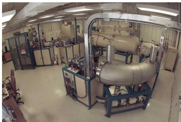
Рисунок 2: Масс-спектрометр, используемый для радиоуглеродного анализа. С сайта [2].
