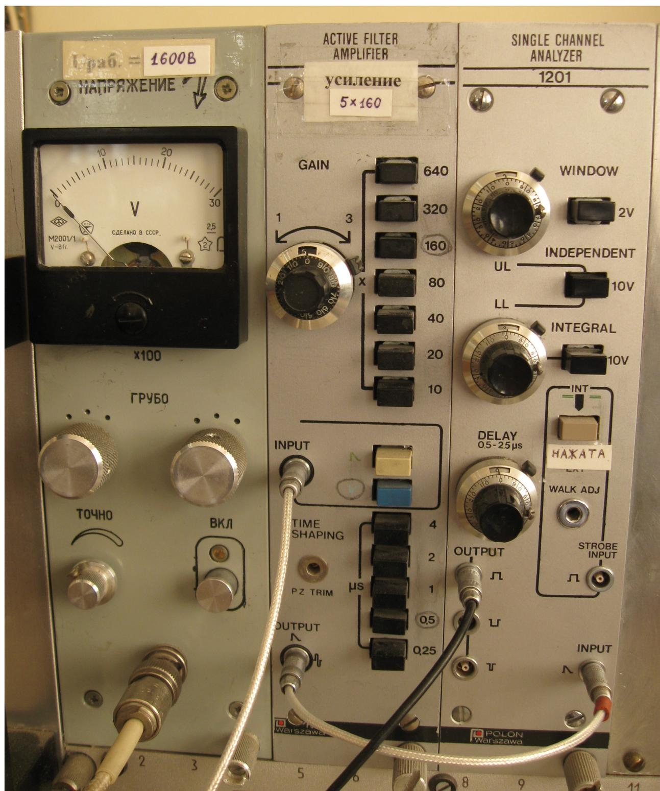
Рисунок 4: Электронная часть схемы детектирования. Не показан блок питания крейта КАМАК. На некоторых столах две соседние установки имеют общий блок питания. Порядок следования блоков может отличаться на разных установках.
