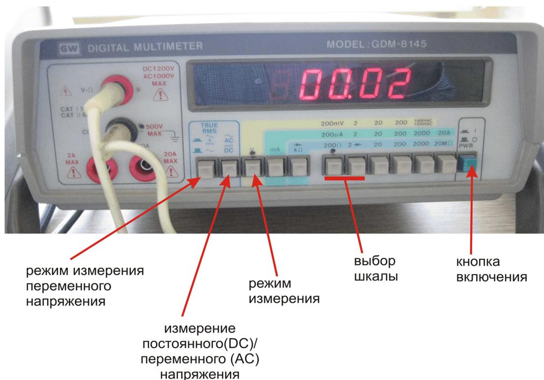
Рисунок 8: Вольтметр (мультиметр) GDM-8145
