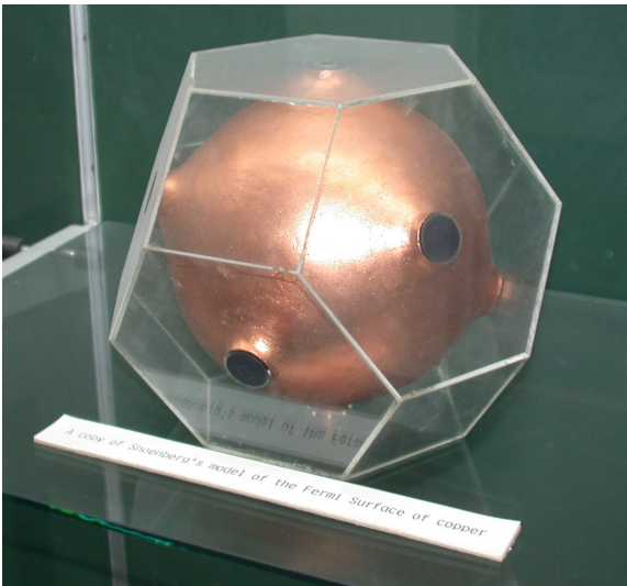
Рисунок 15: Слева: Модель ферми-поверхности меди из музея Кавендишской лаборатории. Стекланный многогранник показывает границы первой зоны Бриллюэна. Справа: соединение ферми-поверхностей в периодической зонной схеме. Модель из музея Кавендишской лаборатории. С сайта [7].
